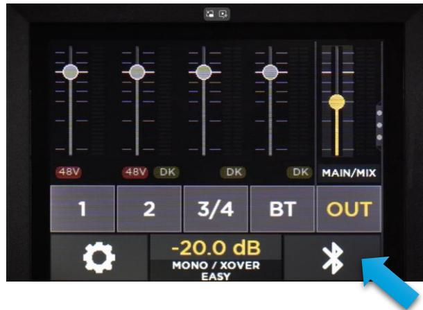
Nach dem drücken auf „PAIR“ kann der Lautsprecher unter „verfügbare Geräte“ auf dem Smartphone oder Tablet ausgewählt und gekoppelt werden.
